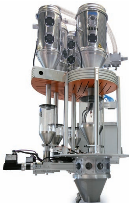
Der kreisförmige Grundaufbau der Dosieraggregate.
