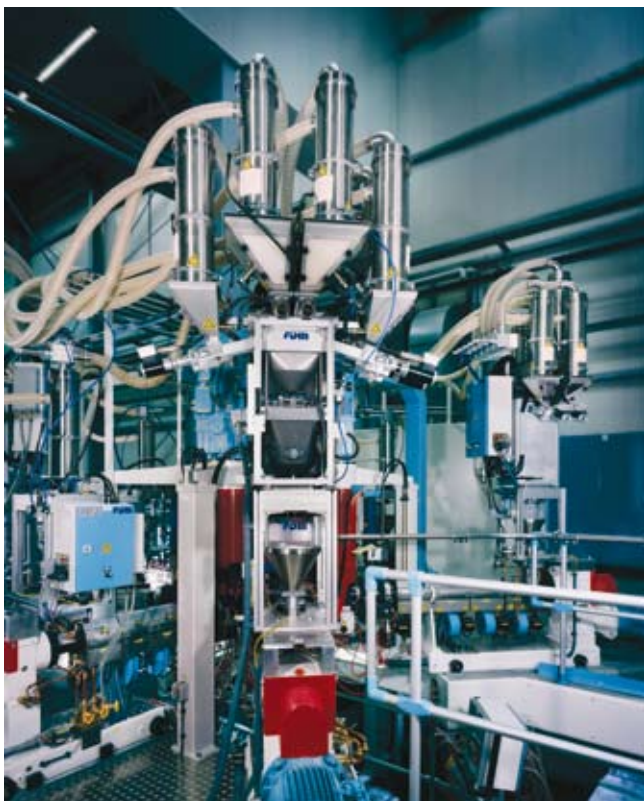
Bild 3: Die komplexe Materialzuführung, Dosierung und Mischung auf einer Kuhne-Mehrschicht-Blasfolienanlage
